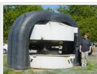
Un électro-aimant de cyclotron au Laurence Hall of Science. Les parties noires sont en acier et se prolongent sous terre. Les bobines de l'aimant sont situées dans les cylindres blancs. La chambre à vide se situerait dans l'espace horizontal entre les pôles de l'aimant.
